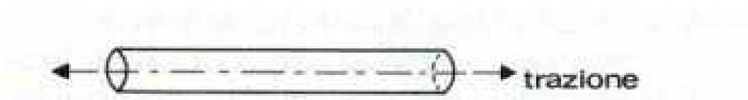
Esiste un valore di forza oltre il quale il materiale si **deforma** in modo **permanente** (snervamento) e si rompe.
