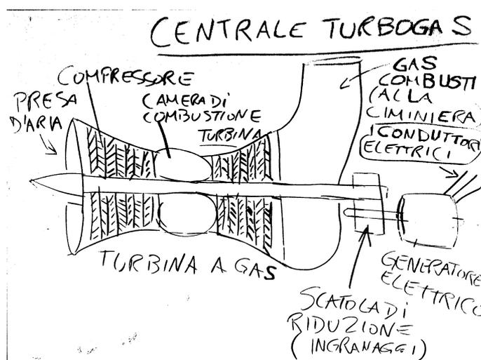
Nella centrale turbogas una **turbina a gas** alimentata a **cherosene** o gas naturale produce **energia meccanica** che aziona un **generatore elettrico**.
