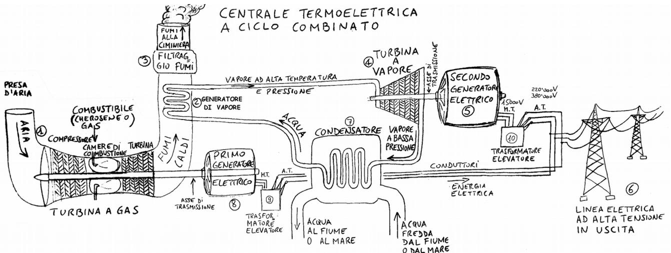
La centrale a ciclo combinato è l'unione di una centrale turbogas e una di centrale termoelettrica di tipo tradizionale. Essa possiede **due generatori elettrici**: uno (8) è azionato da una **turbina a gas**, l'altro (5) da una **turbina a vapore** (4).
